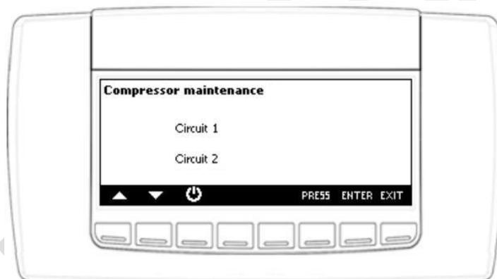
Нажмите кнопку **ENTER**, чтобы просмотреть часы наработки компрессора и кол-во пусков каждого компрессора.
