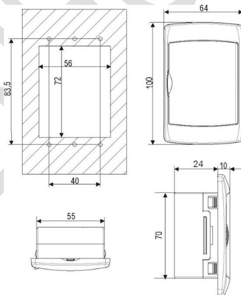
Монтаж на стену: используя вертикальный короб V-KIT (доступен в черном, белом и сером цветах) как показано на схеме ниже:
