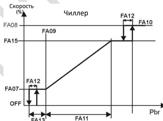
Пропорциональное регулирование вентиляторов в режиме теплового насоса.
