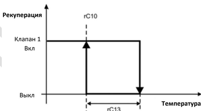
Если сконфигурировано два клапана:
