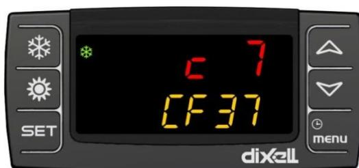
Нижний дисплей показывает параметр CF37 = конфигурацию цифрового входа 8:
