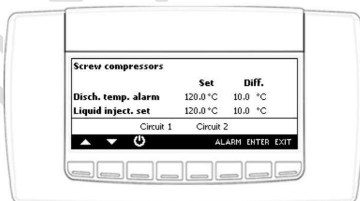
Чтобы посмотреть температуру нагнетания, статус клапана впрыска жидкости и статус клапана разгруженного пуска:
