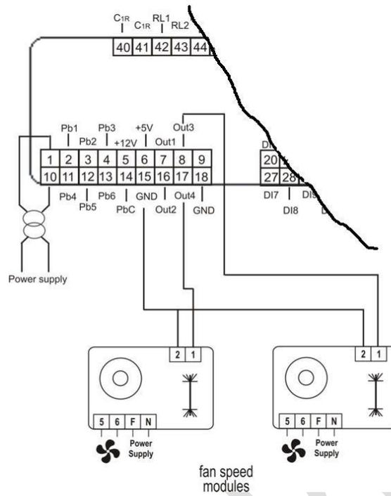
**54.1 ПРОПОРЦИОНАЛЬНЫЙ ВЫХОД ДЛЯ УПРАВЛЕНИЯ ВЕНТИЛЯТОРАМИ КОНДЕНСАТОРА ИЛИ ДЛЯ УПРАВЛЕНИЯ КОМПРЕССОРОМ С ИНВЕРТОРОМ ИЛИ УПРАВЛЕНИЯ ВНЕШНИХ РЕЛЕ**
