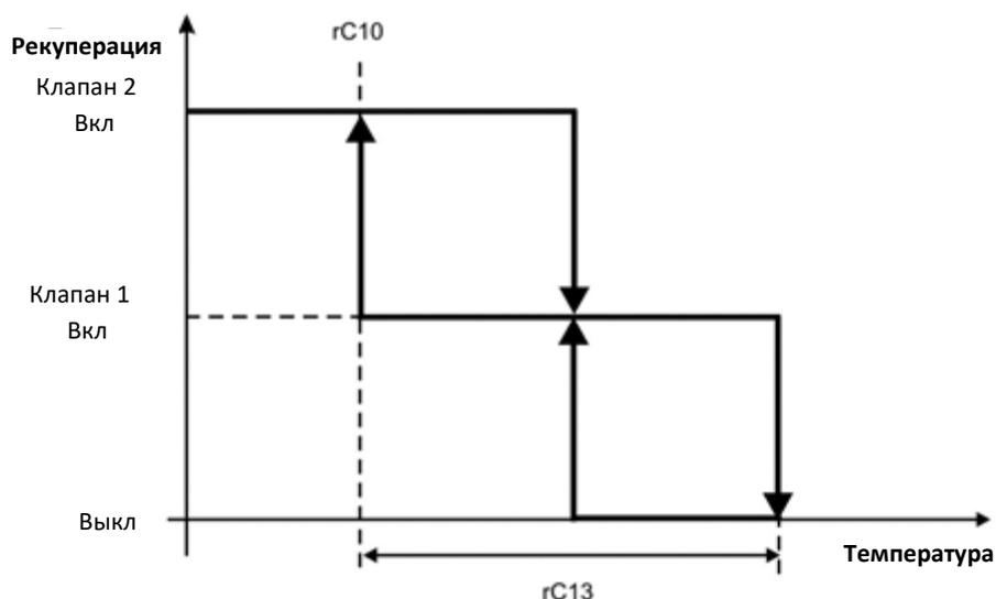
Если цифровой вход рекуперации тепла активен и, если температура рекуперации тепла ниже, чем порог активации первого клапана, клапан рекуперации будет активен пока контур включен. Если работают оба контура, первым активируется клапан рекуперации тепла контура 1, и затем активируется клапан рекуперации тепла контура 2.
