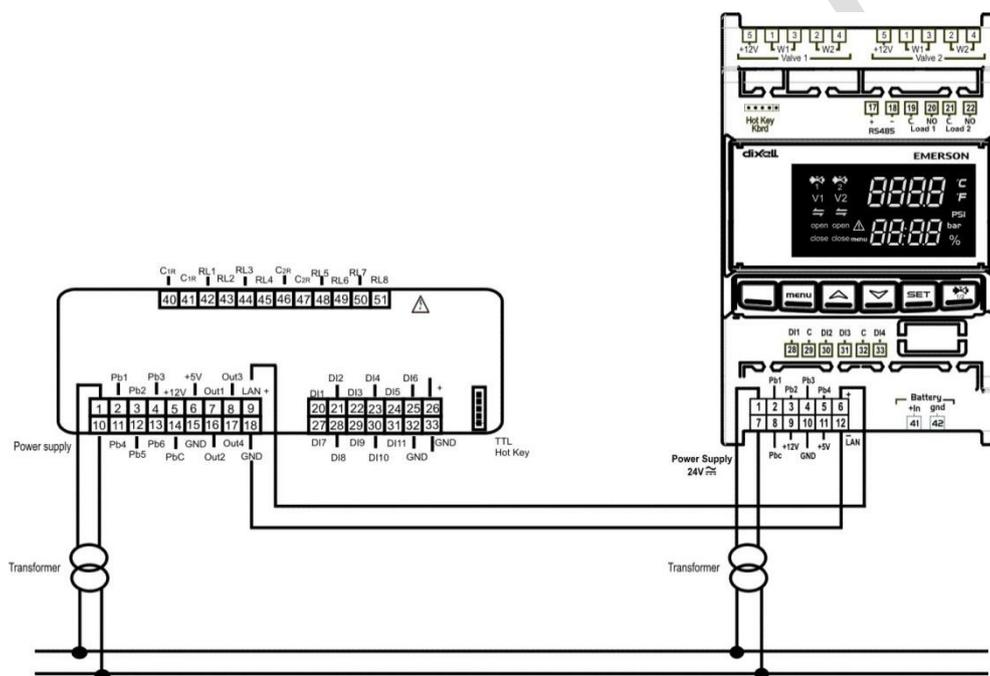
Подключение к одному трансформатору. Напряжение питания контроллера iChill и расширительного модуля должно быть 24V пер./ пост. тока).
