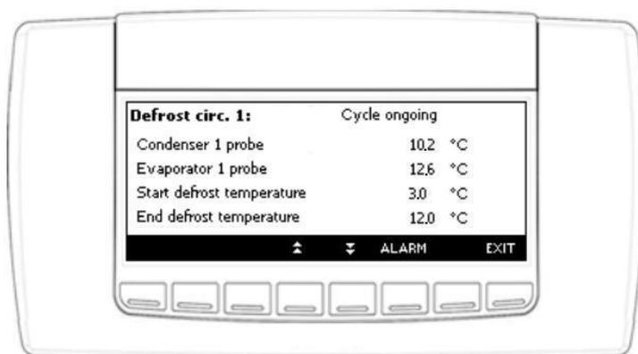
Если включена комбинированная оттайка, то с помощью кнопок
